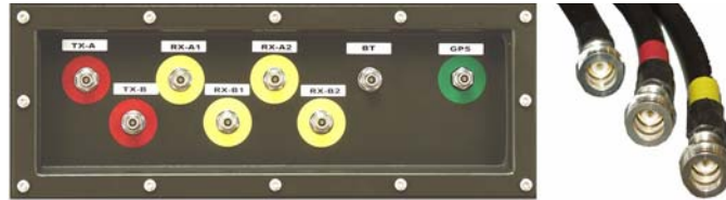
Рис. 2-14 Панель подключения VEM, ВЧ-разъемы и пример быстросъемных ВЧ-разъемов
