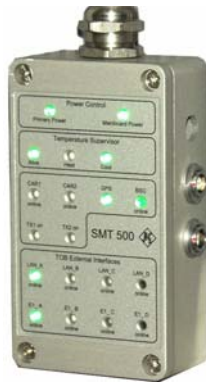
Рис. 4-3 Контроллерный терминал SMT-500 для ТОВ-500
