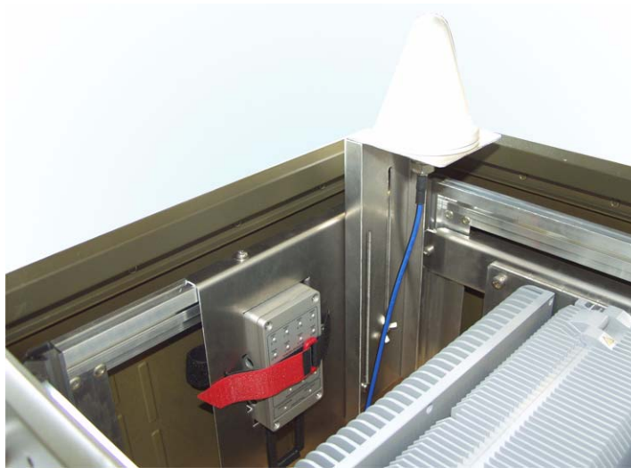
Рис. 4-4 Контроллерный терминал SMT-500 в держателе модуля BSM
